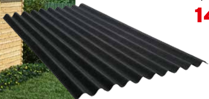
Bitumenwellplatte schwarz 18988 200 x 95 cm Wellenhöhe: 38 mm Wellenzahl: 10 Gewicht: ca. 2,9 kg / m 2
