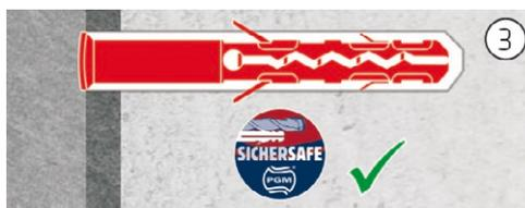
Dübel einstecken - sicherer Dübelhalt und max. Sicherheit.
